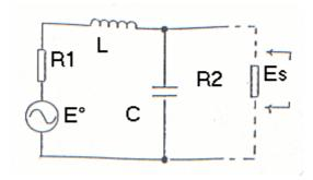
E°= tension induite R1=résist. de la loop (R1=Rp (perte ohmique)+ Rr (résit.rayonnement)) C=capacité (parasite +accord) L=self de la loop R2=résist. de charge Es= tension de sortie
