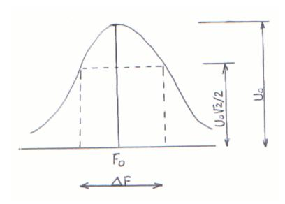
On utilise le même montage que pour mesurer Cp, mais cette fois on déterminera le delta F (qui encadre la fréquence de résonance  $F^{\circ}$ ) pour lequel on passe de  $U^{\circ}$  (le maximum à  $F^{\circ}$ ) à  $U^{\circ}*0,707$ .
